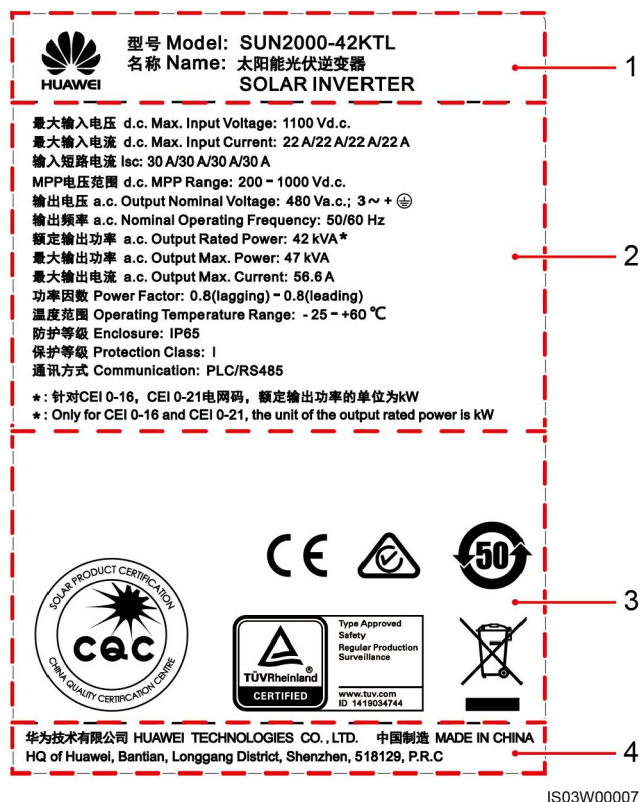
Rysunek 2-9 Tabliczka znamionowa falownika SUN2000-42KTL
