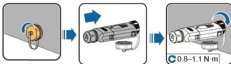
Rysunek 5-10 Montaż WLAN-FE Smart Dongle (komunikacja WLAN)
